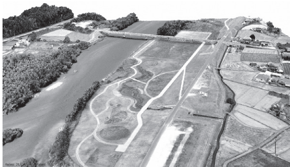
図1 ドローン写真で作った河道の3Dモデル
