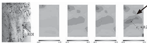
図6 ブタ脊髄神経根付近のひずみ計測結果（破断が開始した矢印付近のひずみが徐々に増加している）
