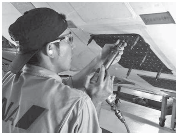
胴体外板へのパッチ当て作業
